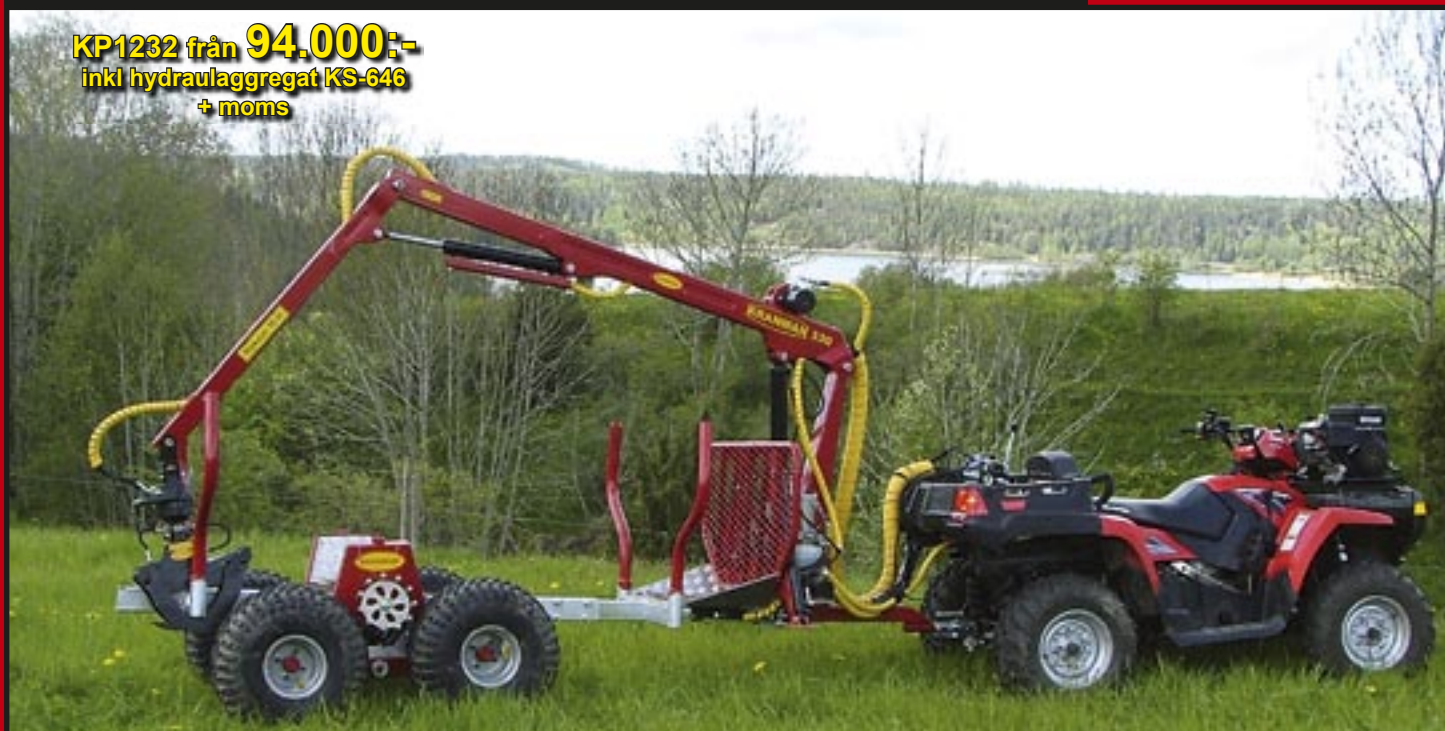
Kranen på bilden är extrautrustad med radiostyrd hydraulvinsch HV500 och ramstyrning RS1800
