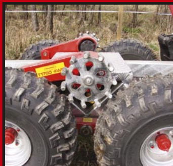
Kranen på bilden är extrautrustad med radiostyrd hydraulvinsch HV500
