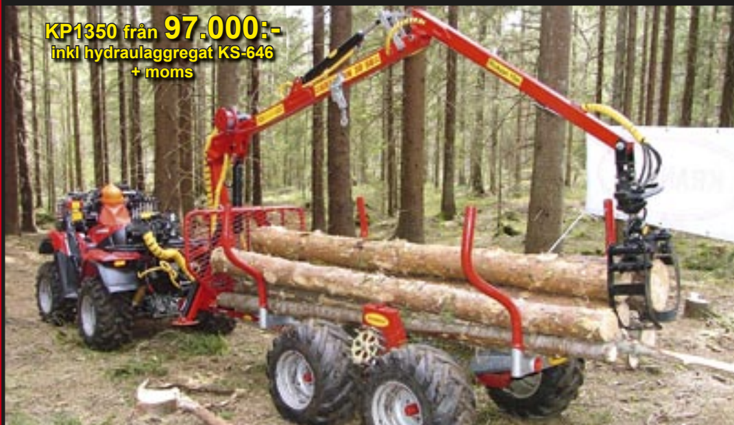
Kranen på bilden är extrautrustad med radiostyrd hydraulvinsch HV500, ramstyrning samt 26x12.00-12" hjul på vagnen.
